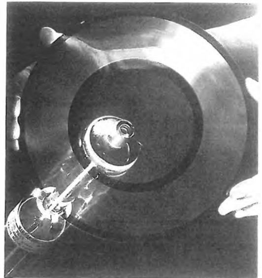
Fig. 18 X - Per la sua corta lunghezza d'onda il fascio del laser He-Ne si presta facilmente alla scansione della traccia video su dischi, incisa sia col sistema a riflessione che con quello (qui sopra) a trasparenza.
