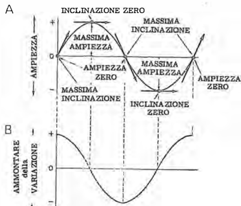
Fig. 48 U - La frequenza della portante varia in seguito alla modulazione di fase ed è perciò anch'essa modulata dall'ampiezza del segnale modulante (indicato in A), secondo i rapporti che si possono qui sopra rilevare. A variazioni rapide d'ampiezza corrisponde il massimo di spostamento di frequenza.
