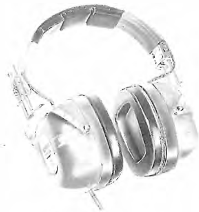
Fig. 58 U - Cuffia per alta fedeltà che abbinata il sistema dinamico a quello ceramico: il primo agisce nella gamma delle frequenze basse. Vi è un dispositivo di incrocio delle due gamme di frequenza, la cui somma va da 18 a 22 000 Hz.
