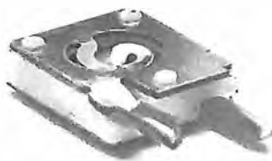
Fig. 37 AB - Uno dei primi modelli di filtri ceramici per risonanze sul valore della Media Frequenza dei ricevitori per modulazione d'ampiezza. Tolleranza sulla frequenza: 8,5 \times 10^{-5} . L'ingombro è di 8 \times 7,5 \times 3 mm.
