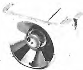
Fig. 50 X - Con un diodo di questo tipo (LD 242) è il televisore (o l'apparecchio radio, o l'amplificatore) che trasmette il segnale B.F. modulando gli infrarossi del diodo (950 nm). Il segnale è raccolto ovunque, nel locale, a mezzo di cuffia attrezzata. Si noti il dissipatore di calore, che funziona, per la sua forma, anche da riflettore.
