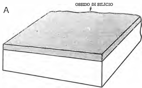
Fig. 20 W - La piastrina di silicio dopo diversi trattamenti che rendono speculare la sua superficie è portata ad alta temperatura in ambiente ossidante: si forma, allora, uno strato di ossido che ha la particolarità di una struttura assai resistente alla temperatura, ad agenti chimici in genere, ed è un buon isolante.
