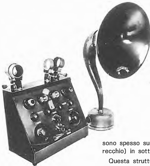
Fig. 1 AB - Prima dell'applicazione del circuito supereterodina si sfruttava — per aumentare la sensibilità — il principio della « reazione ». I trasformatori di Alta frequenza erano formati da bobine (avvolgimento detto « a nido d'ape ») con accoppiamento comandabile. La coppia sulla destra, facente parte del circuito rivelatore, mediante l'accostamento portava lo stadio al limite di innesco (reazione).
