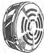
Fig. 17 U - Qui sopra una capsula microfonica piezoelettrica e, a lato, due illustrazioni relative al principio di funzionamento di questo tipo di microfono. Le vibrazioni della membrana (H) provocano una deformazione elastica della piastrina (C) di cristallo o di ceramica. Questa, per il fenomeno della piezoelettricità, converte le sollecitazioni meccaniche in una debole tensione elettrica.
