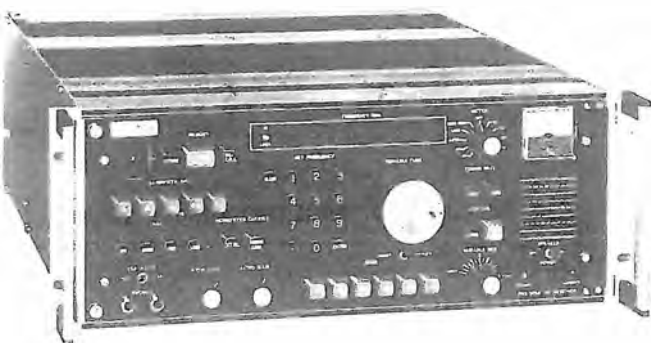
Fig. 8 AB - Ricevitore professionale per telecomunicazioni adottante le tecniche di elaborazione digitale (circuiti logici) per l'esecuzione delle diverse operazioni, l'indicazione della frequenza d'accordo e l'eventuale programmazione. Costa quasi dodici milioni di lire.
