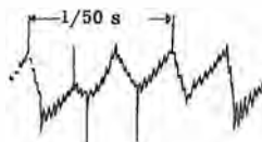
Fig. 58 Y - Oltre ai disturbi di cui alle illustrazioni precedenti vi possono essere disturbi indipendenti dall'amplificatore. È questo il caso, ad esempio, del ronzio prodotto dalla vicinanza di lampade fluorescenti.
