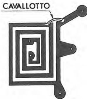
Fig. 64 CD - La bobina L è formata da una pista di rame prevista sulla Basetta 1, a circuito stampato, come si può osservare sul disegno (figura 65 CD); la sua gamma è: 60 ÷ 90 MHz. Col cavalletto si riduce l'induttanza e perciò, volendo, si ha il passaggio a 90 ÷ 140 MHz.
