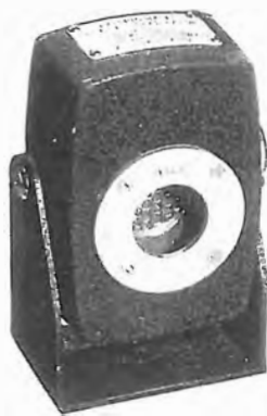
Fig. 8 U - I misuratori di livello sonoro, anche se molto stabili, è opportuno siano periodicamente controllati. Questo calibratore acustico meccanico: un certo numero di piccole sfere vengono fatte cadere su una membrana. Il rumore così generato ha ampiezza costante, spettro di frequenza uniforme, e serve per la calibrazione. Non vi è necessità di alimentazione. Il fonometro da tarare viene collocato col suo microfono alla distanza di 8 cm dall'apertura.
