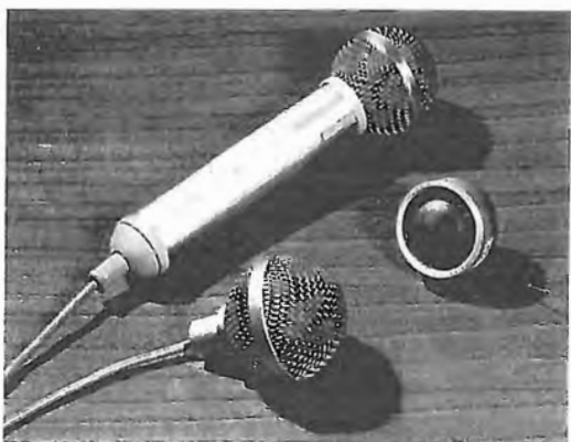
Fig. 1 U - Il microfono oggi assume forme funzionali, atte cioè a conferirgli maggiore efficacia e comodità di impiego a seconda degli usi cui è destinato. Vi sono così, tipi che captano il suono da ogni direzione ed altri, invece, che sono unidirezionali. A volte nell'impugnatura sono presenti dispositivi di correzione e di amplificazione. La fedeltà di riproduzione raggiunta dai modelli professionali è notevole.
