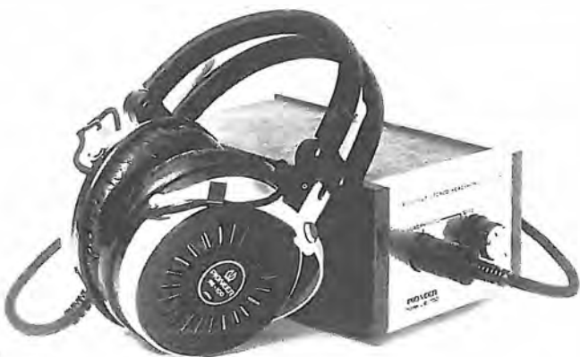
Fig. 53 U - Questa cuffia utilizza gli elettretti e può perciò riprodurre fedelmente una gamma da 20 a 35 000 Hz; l'armatura del condensatore, in poliestere, è di soli 4 \mu di spessore. Ciascun padiglione può funzionare anche da microfono. Richiede l'adattatore illustrato accanto.
