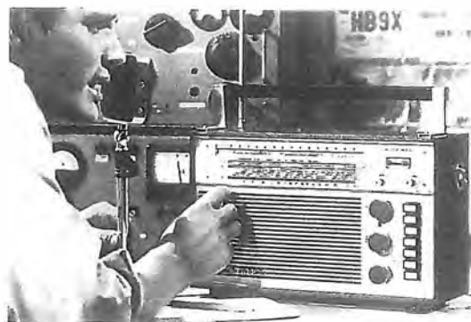
Fig. 51 CD - L'inizio dell'attività può avvenire con l'impiego di modeste apparecchiature: per il trasmettitore non è difficile la realizzazione mentre per il ricevitore può servire anche (comunicazioni in fonìa) un buon apparecchio per onde corte, a bande espanse.
