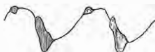
Fig. 54 Y - Presenza di oscillazioni ad Alta Frequenza, in un segnale di Bassa Frequenza. Tali oscillazioni, benché non udibili in altoparlante, possono determinare deformazioni anche notevoli come si vede chiaramente dalla figura.
