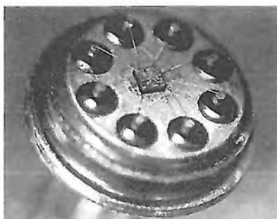
Fig. 27 W - Le diverse fasi di un'operazione di compressione saldatura dei terminali con le piazzuole previste all'uopo sulla superficie dell'integrato: vedi E della figura 20 W.
