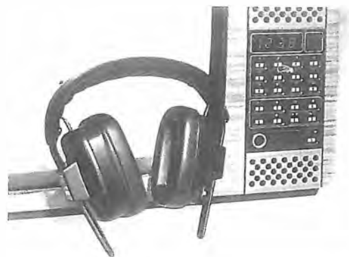
Fig. 59 U - Una tra le più recenti applicazioni della cuffia è quella che la vede utilizzata senza alcun cordone di collegamento; essa diventa praticamente un ricevitore di raggi infrarossi, modulati dal segnale: in questo caso, dall'audio di un televisore.
