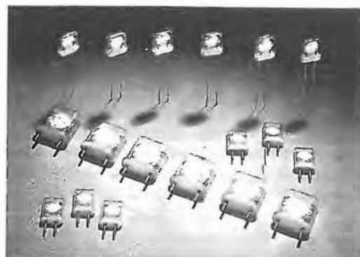
Fig. 22 CD - La custodia può essere metallica o, anche, in vetro, col cristallo e le armature sigillati sotto vuoto: in quest'ultimo caso (esigenze militari) si ha una stabilità cinque volte più alta. Nelle dimensioni più grandi le frequenze vanno da 500 kHz a 200 MHz, in quelle più piccole da 5 000 kHz a 200 MHz.
