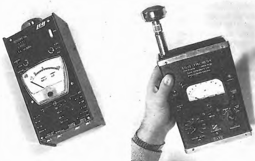
Fig. 7 U - La misura del livello sonoro viene effettuata mediante « fonometri ». Questi modelli — portatili — si equivalgono nel concetto costruttivo: constano di un microfono, amplificatore con attenuatori tarati, circuiti di calibrazione e strumento indicatore. La gamma di livelli misurabili va da 24 a 140 dB; è prevista un'uscita per avviare il segnale o ad un oscillografo o ad una cuffia.
